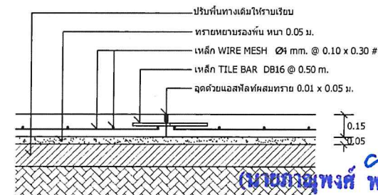
แบบขยาย ค ขยายรอยต่อตามยาว (LONGITUDINAL JOINT)
