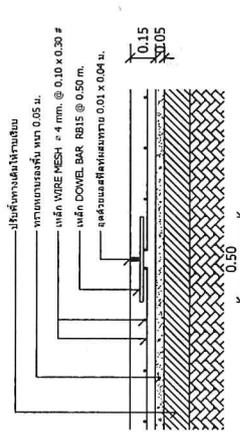
แบบขยาย (CONSTRUCTION JOINT) ทุกระยะ 5 เมตร
